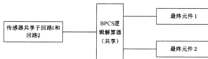
图 A.2 同一场景下共享传感器的 BPCS 回路
