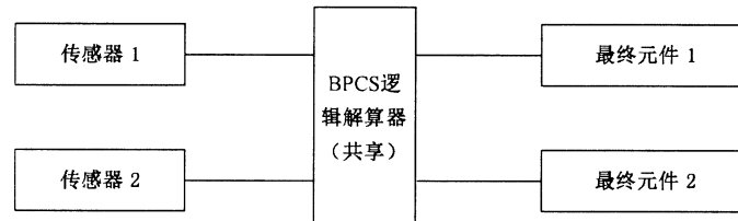
图 A.1 同一场景下多个回路的典型 BPCS 逻辑计算器
